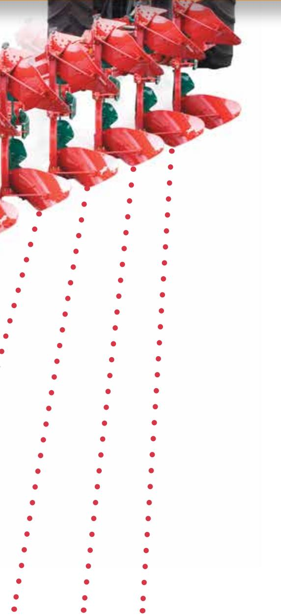
**Ajuste sin escalonamientos del ancho de trabajo, desde 30 cm a 50 cm (12" - 20"), según el modelo.**
