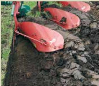
Los cuerpos de arado Kverneland están fabricados con acero especial térmicamente tratado y que es sometido a un proceso especial desarrollado por Kverneland que les da la máxima resistencia al desgaste en combinación con la flexibilidad necesaria para absorber los impactos.
