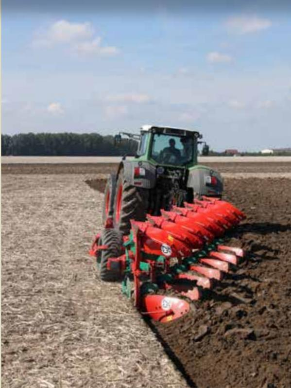
Los arados PG incorporan el sistema de protección ante impactos de Ballesta y los RG se protegen mediante fusible.
