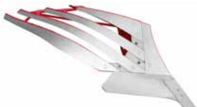
**N° 30** Cuerpos de arado especiales diseñados con una vertedera de tiras que mejora la limpieza cuando se trabaja en suelos muy pegajosos. Capaz de trabajar entre 20 y 35 cm (8 y 14 pulgadas) de profundidad.
